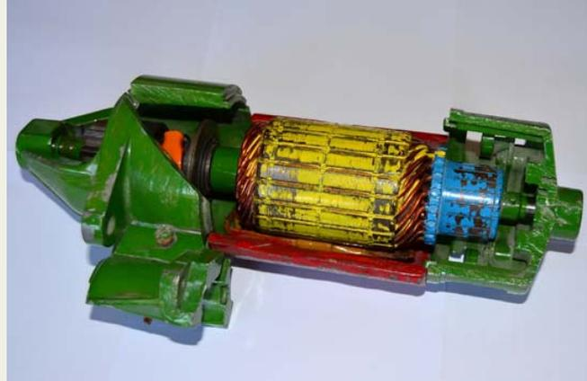
Sección de un motor de arranque de un automóvil. Detalle de rotor y colector de delgas. (A.L.B.)
